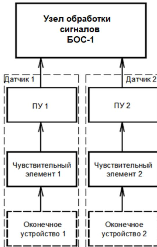
Рисунок 1.1 - Структурная схема извещателя
